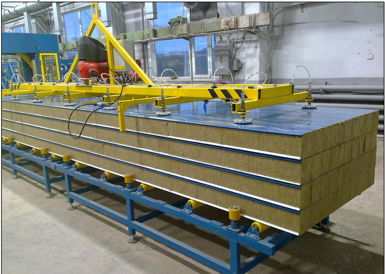
Рис. 13. Траверса с вакуумными захватами
