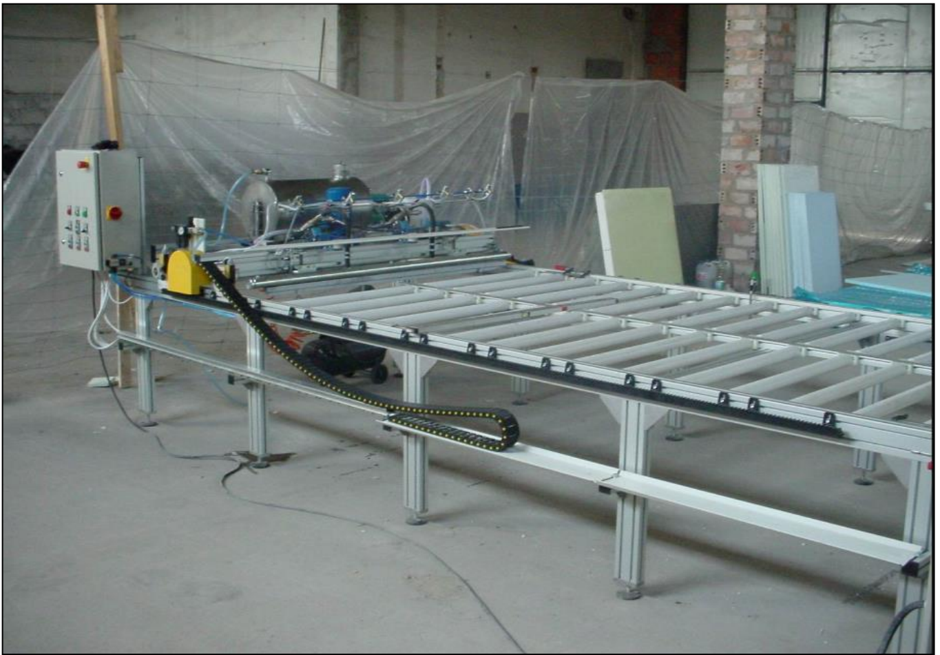
Рис. 7. Установка для нанесения клея + рольганг монтажный
