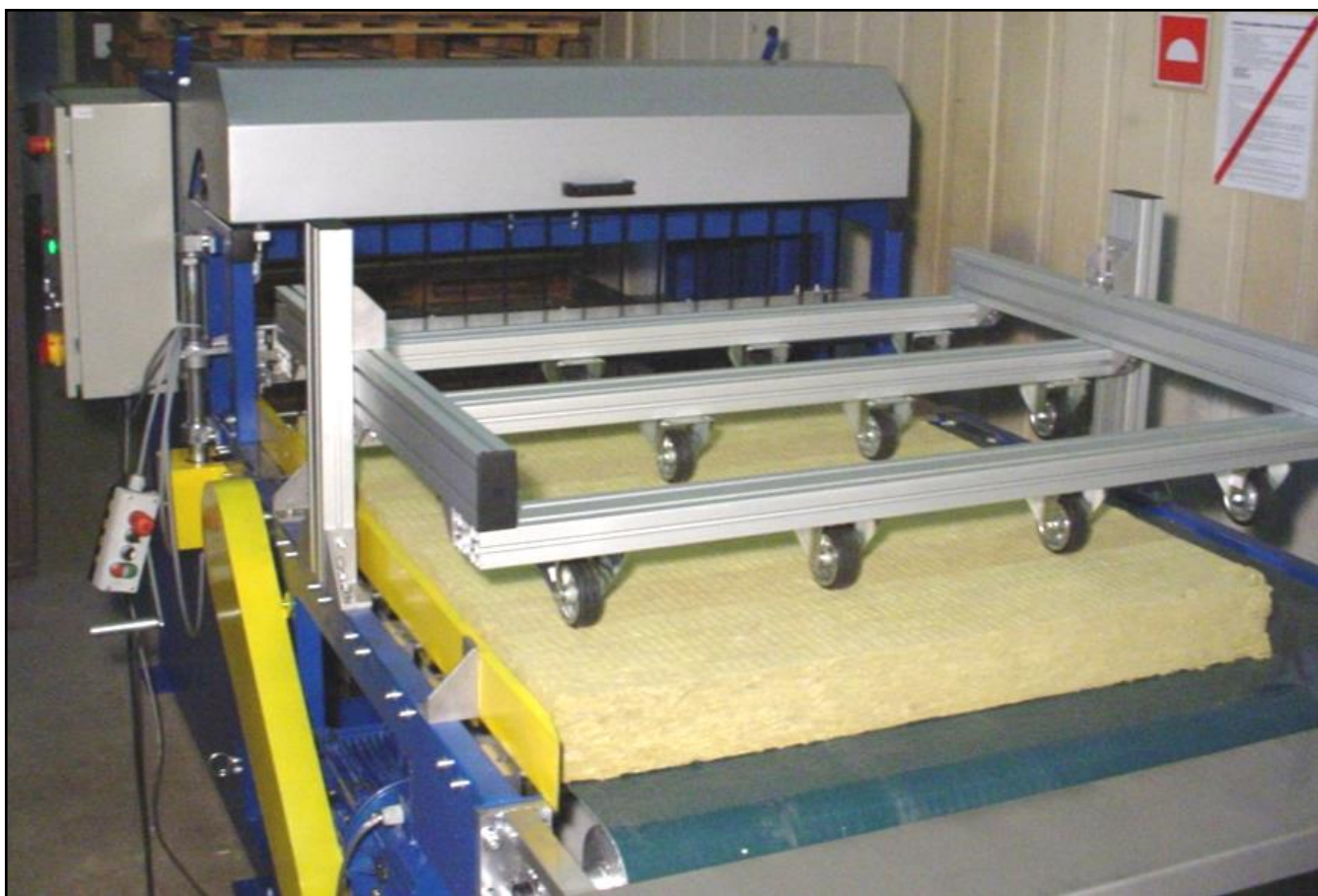
Рис. 6. Общий вид установки для резки минеральной ваты
